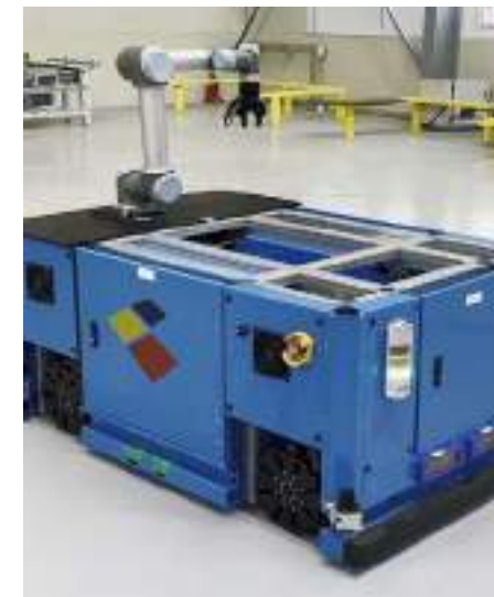
사례 13) T사 5kg 부품 조립 및 이송 Robot Type AMR
