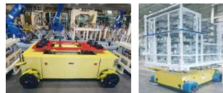
사례 1) S사 2ton 자동차 부품 이송 Lifting Type AMR
