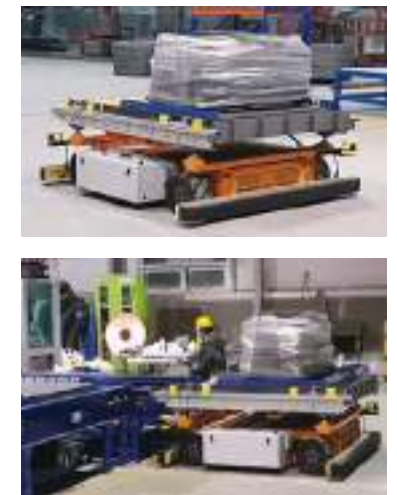
사례 15) H사 1ton 철자재 부품 이송 Conveyor Type AMR
