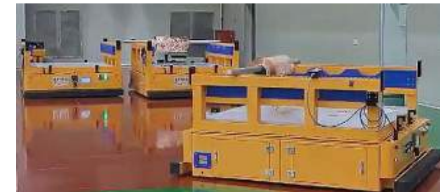
사례 8) L사 말레이시아 5ton Roll 이송용 i-AGV
