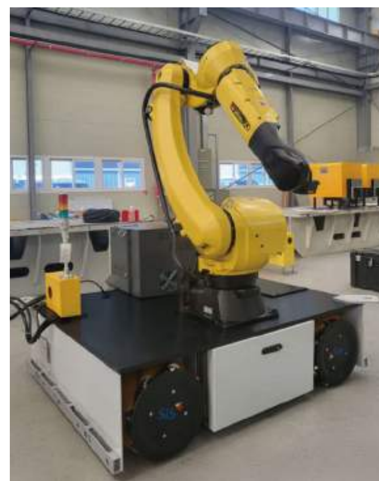
사례 2) T사 30kg 부품 조립 및 이송 로봇 Type AMR
